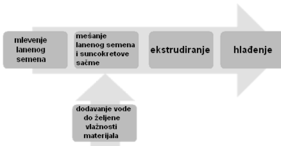
Slika 2. Šematski prikaz linije za proizvodnju ko-ekstrudata Figure 2. Sheme of co-extrudate's production process
